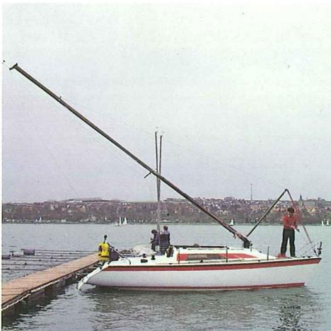
Mit Hilfe des Spinnakerbaumes<sup>\*)</sup>, der als Jütt verwendet wird, ist der Mast mit den angeschlagenen Wanten im Handumdrehen gesetzt.
