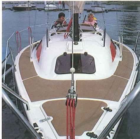
Kantenfrei in das Deck eingearbeitet ist der rutschfeste Decksbelag\*). Beidseitig des Kajütaufbaus sind breite Laufflächen auf Deck.
