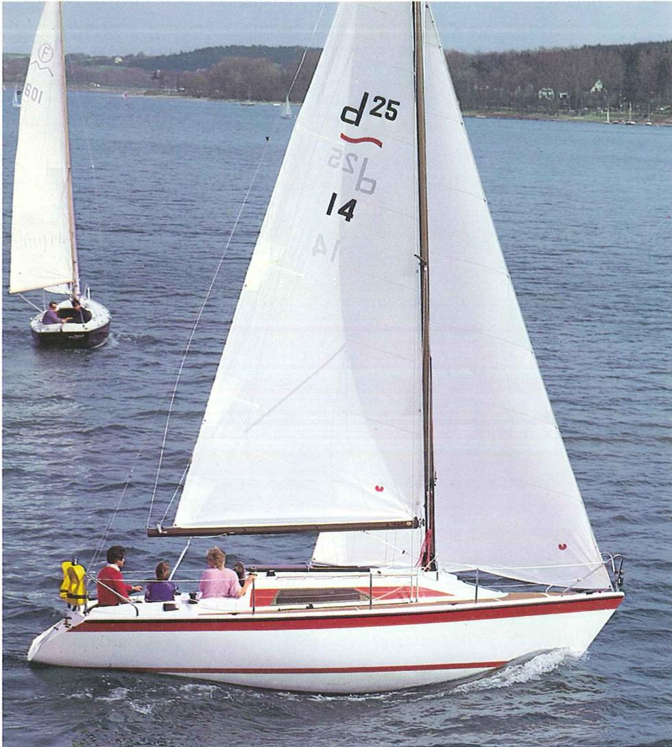
An der Linienführung der DEHLER 25 erkennt man die Vorzüge modernen Yachtbaus. Die große Rumpfbreite und das flache Unterwasserschiff ergeben hohe Anfangsstabilität. Das Boot liegt gut auf dem Ruder,
