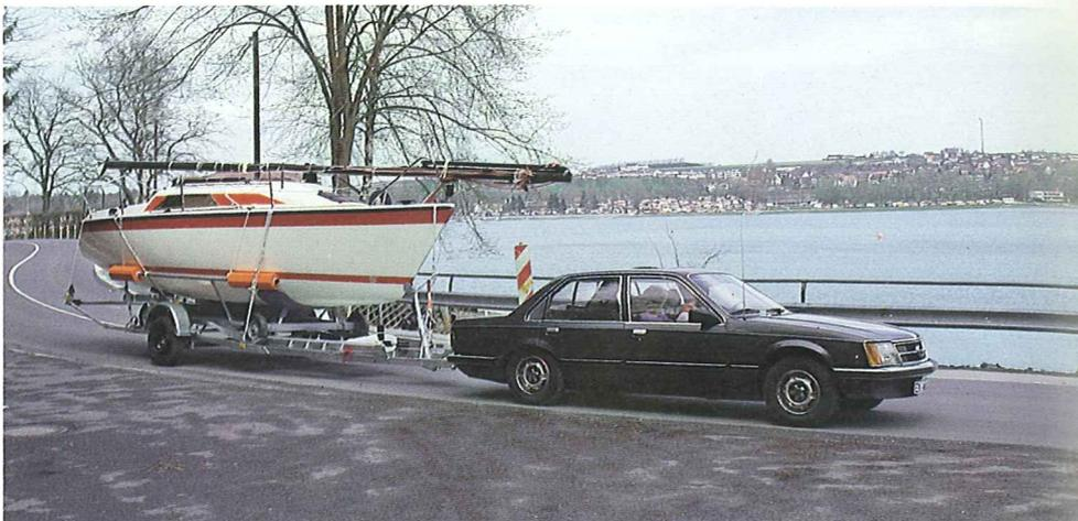
Durch den Hubkiel und das herausnehmbare Ruderblatt hat die DEHLER 25 eine sehr niedrige Transporthöhe beim Trailern. Das bedeutet tiefer Schwerpunkt und erlaubt ein sicheres Chauffieren auch über
