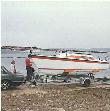
Über jede normale Slippbahn kann die DEHLER 25 mit dem schwimmbaren Slippwagen zu Wasser gelassen werden.
