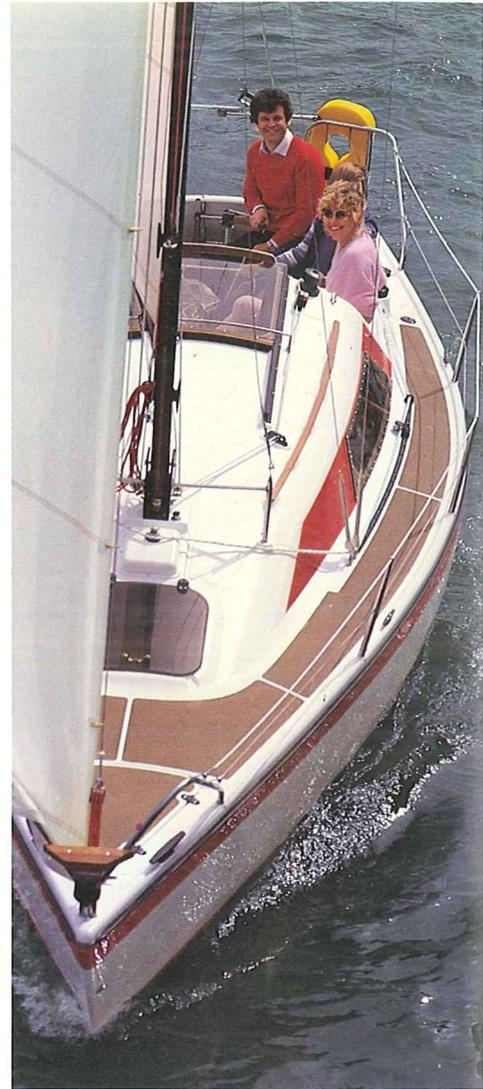
Übersichtlich und funktionell ist das klare Deckslayout der DEHLER 25. Alle Fallen und Strecker werden über Umlenkrollen ins Cockpit geführt\*). Die Crew sitzt geschützt hinter dem hohen Kajütaufbau, der nach aerodynamischen Gesichtspunkten gestaltet ist.
