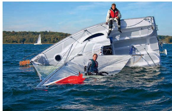
**Mit Sack gesichert** Stürzt jemand aufs Segel und stützt kein Kenterkissen das Rigg, würde der Mast unter Wasser gedrückt, und das Boot könnte durchkentern
