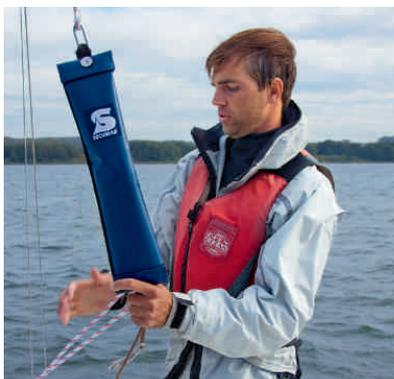
**In Vorbereitung** Sie funktionieren wie eine automatische Rettungsweste, nur schützen sie nicht den Segler, sondern das Boot: Kenterschutzkissen. Die Montage der 160 bis 172 Euro teuren Lufttaschen ist simpel: An einem freien Fall werden sie in den Masttopp gezogen und mit einer Leine nach unten gesichert. Alternativ kann der Segelmacher auch am Großsegelkopf zwei Befestigungslaschen anbringen
