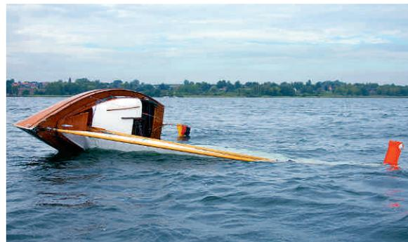
**Hohe Schwimmlage** Auftriebskörper halten das Boot für einige Minuten oben, der Holzmast verhindert ein Durchkernern. Der Kentersack bringt Sicherheit
