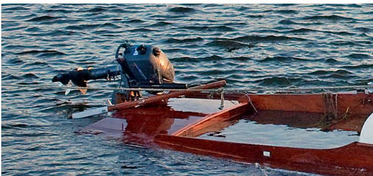
**Umgehend reinigen** Einmal getaucht, altert der Flautenschieber rasend schnell. Auf keinen Fall anreißen, nur versuchen, das Wasser weitgehend aus dem Motor zu bekommen (Zündkerze und Filter raus). Dann binnen 24 Stunden einem Fachmann zur Reinigung und Wartung übergeben
