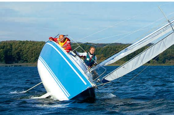
**Abdrift satt** Krängung dieses Ausmaßes ist nur mit fehlerhaftem Steuern oder falschem Gewichtstrimm zu erreichen. Meist läuft das Boot zuvor aus dem Ruder
