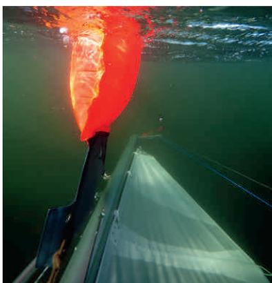
**Im Einsatz** Taucht der Mast bei einer Kenterung unter Wasser, löst der Automat aus, und binnen Sekunden sorgen je nach Modell 20 oder 40 Liter für sicheren Auftrieb – das Boot kann nicht mehr durchkentern. Schiffe mit Holzmast benötigen nicht zwangsläufig so ein Kenterschutzkissen, da das Holz selbst über ausreichend Auftrieb verfügt. Bei breiten Booten mit ungünstigem Hebel könnte aber ein unterstützender Einsatz hilfreich sein
