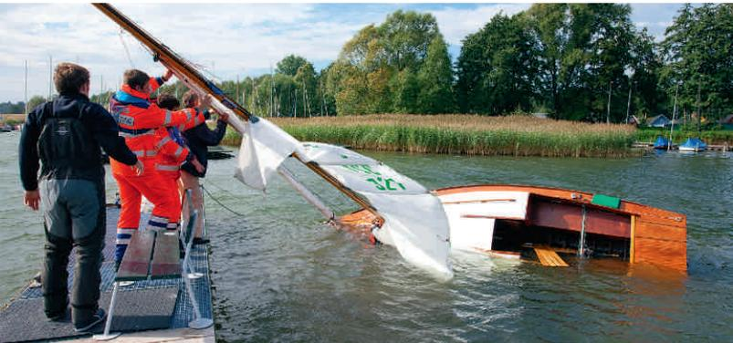
**Kontrolliert aufrichten** Im geschützten Flachwasserbereich kann die senkrechte Schwimmelage wiederhergestellt werden. Läuft Wasser über den Schwertkasten nach, besteht nicht die Gefahr, dass ein vollgeladenes Boot auf Tiefe geht. Pumpen bereithalten
