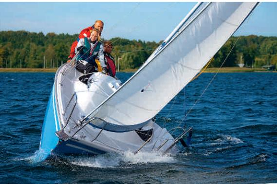
**Voll in Fahrt** Wenig Lage fühlt sich aufgrund der großen Breite nach mehr an, als es wirklich ist. Die Formstabilität ist auf diesem Bild maximal
