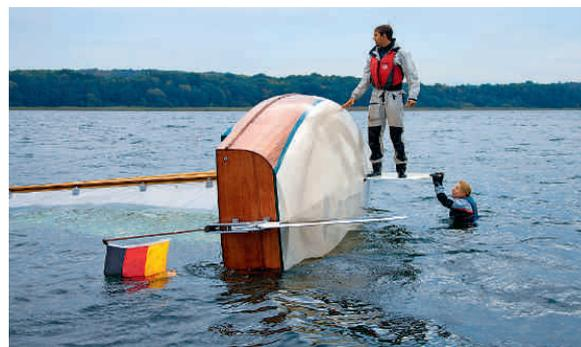
**Aufrichten möglich** So hoch schwimmend ist es noch sinnvoll, den Mast von einem Helfer aus dem Wasser heben zu lassen
