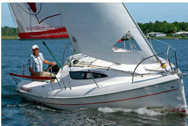
**Vorschiffsformen** Ein schlankes Vorschiff, wie das der Raptor 26 (oben), sorgt für ein lebendiges Segelverhalten. Ein fülliger Spant, im Bild unten die Fan 23 Balt, bietet dagegen bei zunehmender Lage mehr Stabilitätsreserven
