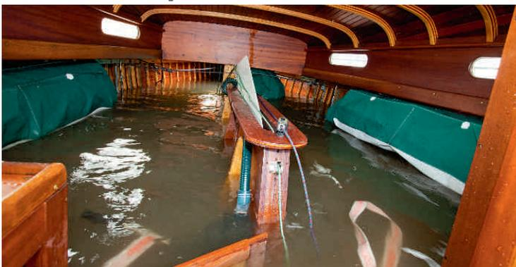
**Beladung kompensieren** Je höher ein Schiff im gekenterten Zustand aufschwimmt, desto sicherer. Neuere Boote verfügen meist über ausreichend fest eingebaute luftdichte Räume, bei alten Schiffen muss mittels Luftsäcken (im Foto rechts und links) Reisegepäck kompensiert werden
