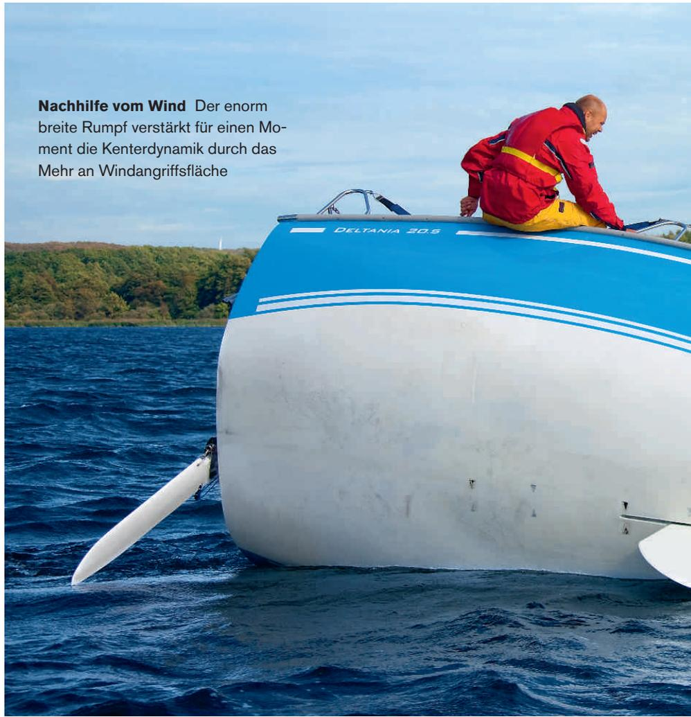
**Nachhilfe vom Wind** Der enorm breite Rumpf verstärkt für einen Moment die Kenterdynamik durch das Mehr an Windangriffsfläche
