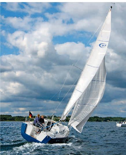
**Öffnung** Mit gelöstem Baumniederholer und gefierter Schot verwindet sich das Großsegel und lässt den Druck im Topp ab
