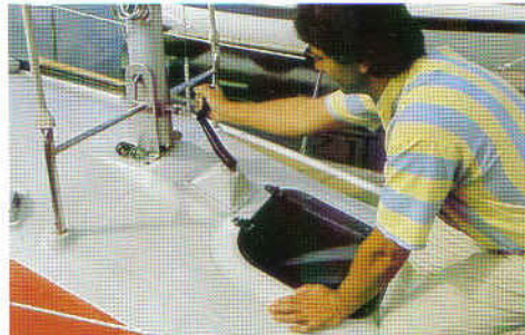
Herabdrehen des Hubkiesels über eine Spindel. Vorteil des Hubkiesels: niedriger Schwerpunkt beim Trailern und Slippen; Möglichkeit, flache Reviere und Tidengewässer anzulaufen (Klapptruder).
