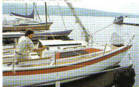
Mit Hilfe des Spi-Baumes und der Mastlege-Vorrichtung wird über die Fallwinch der Mast gesetzt. Die Fallklemmen sichern in jeder Stellungsphase.
