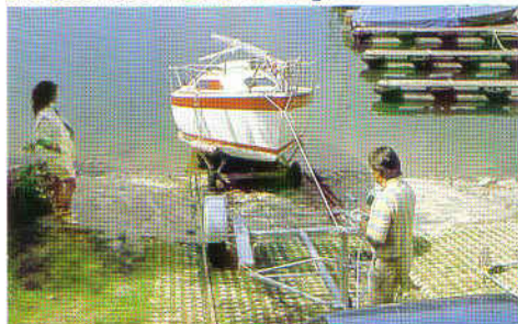
Zuwasserlassen über jede feste Slippbahn, ohne Hilfe eines Kranes.
