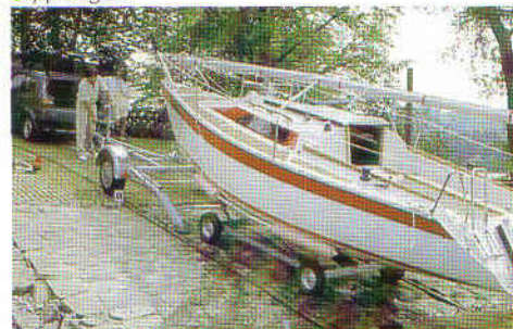
Mit der Seilwinde werden Boot und Slippetrailer aus dem Wasser gezogen. Wasserballast wird durch ein Zugventil abgelassen.
