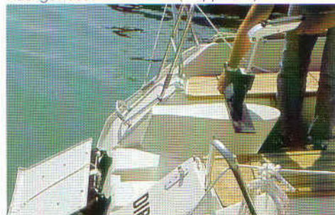
Das Ruder mit der Pinne wird in die Aussparung im Cockpitboden gesteckt. Das Schiff ist in etwa 30 Minuten segelfertig.
